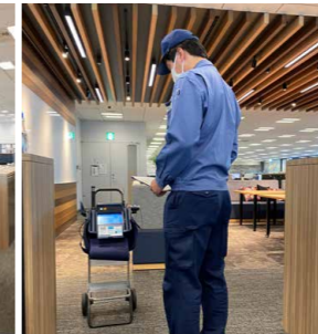
定期的な室内空気環境調査
